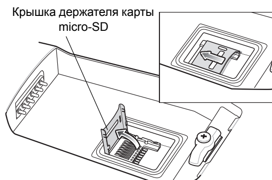
Рис. 1-2 Установка карты microSD
