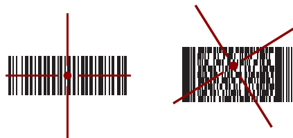
Рис. 3-4 Рамка наведения имидж-сканера: центровка на штрихкоде
